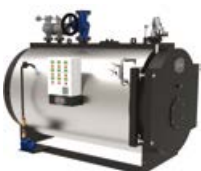
VAPOPRES LVPq VAPOPRES LVP 150 - 4.000 kg/h Generatore di vapore a bassa pressione a tre giri di fumo di cui due in camera di combustione. Low pressure steam boiler with three flue passes, two in furnace.
