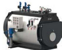
VP 3G F 500 - 4.000 kg/h Generatore di vapore a media pressione a tre giri effettivi di fumo. Medium pressure steam boiler with three flue passes.
