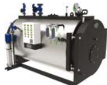
VAPOPRES HVPq VAPOPRES HVP 150 - 5.000 kg/h Generatore di vapore a media pressione a tre giri di fumo di cui due in camera di combustione. Medium pressure steam boiler with three flue passes, two in furnace.
