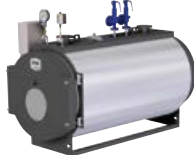
PREX N ASH 160 - 3.500 kW Caldaia per acqua surriscaldata fino a 200°C, a tre giri di fumo di cui due in camera di combustione. Superheated water boiler max temperature 200°C, with three flue passes, two in furnace.
